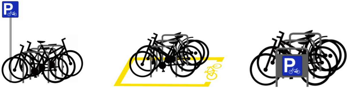
FIG. 3 Tipología en la señalización de los aparcamientos para bicicletas. (1) señalización vertical con S-17; (2) marcas viales; y (3) soporte a modo de pletina en el módulo con señal S-17. DISEÑO: Comité de Bici Urbana Guardabarros.
