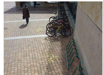
FIG. 4 (1) Sujeción de bicicleta a través de dos puntos a un soporte rígido tipo “U” invertida; (2) atado de las dos ruedas con un solo candado; y (3) fotografía en la que se comprueba cómo los modelos para una sola rueda no tienen la receptividad deseada (Campus Miguel de Unamuno) FOTO y DISEÑOS: Comité de Bici Urbana Guardabarros.
